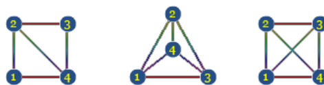
Fig. 26: Un esempio di comportamento di grafo interattivo: a partire dal primo grafo ed aggiungendo il lato (1,3), un algoritmo di visualizzazione classico disegnerebbe il triangolo in seconda figura. Un algoritmo interattivo invece, per preservare la visualizzazione, realizzerebbe la terza.
